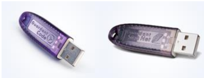
Рис. 1 Внешний вид ключа защиты Guardant
